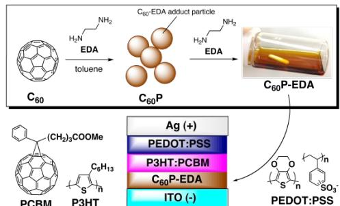
図1 フラーレン-ジアミン付加体をバッファー層に用いた有機薄膜太陽電池
